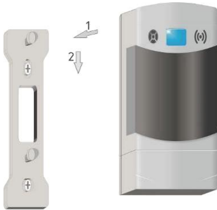
Рисунок Д.3 – Установка сигнализатора на монтажную панель
