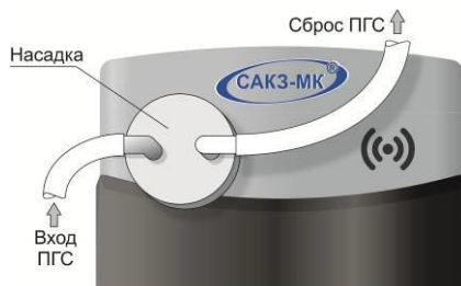
Рисунок Д.2 – Установка насадки для подачи ПГС
