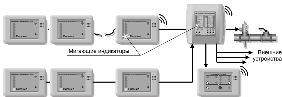
Рисунок 3 – Реакция Системы на обрыв кабеля/неисправность сигнализатора
