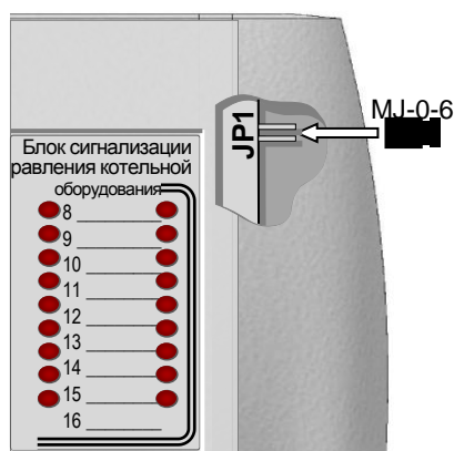
Рисунок 11 – Расположение переключателя типа клапана.
