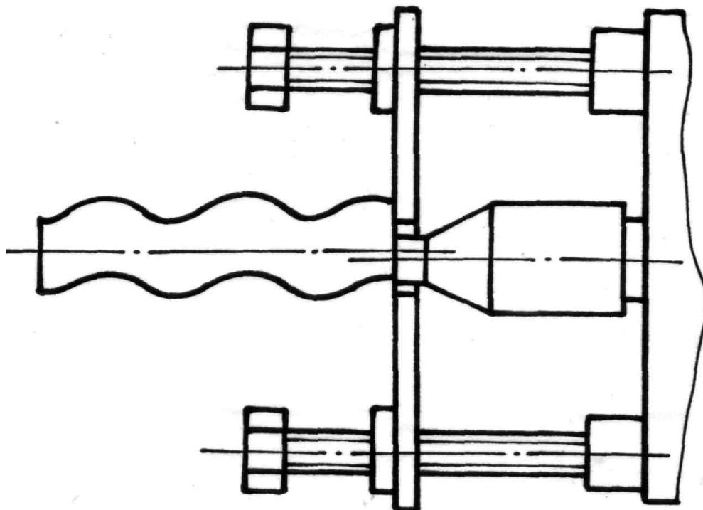
Приспособление для съёма винта.
