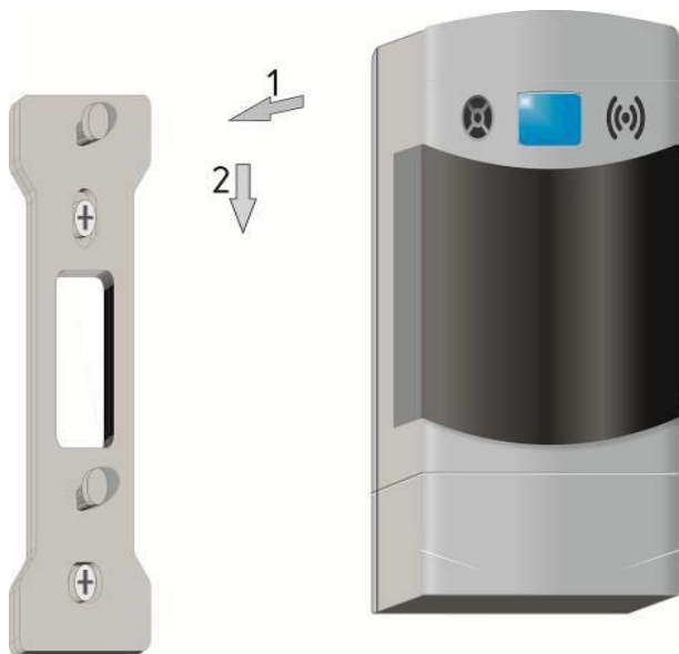
Рисунок Б.3 – Установка сигнализатора на монтажную панель
