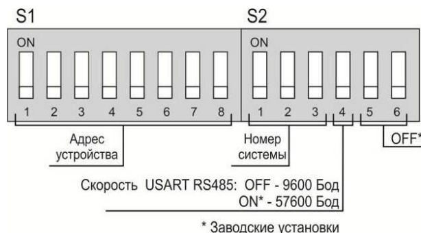
Рисунок 17 – Ретранслятора Р-433. Расположение переключателей.
