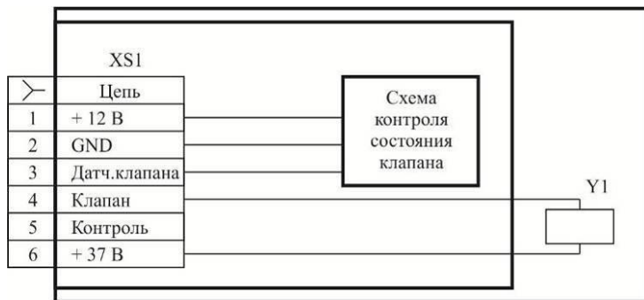
Рисунок 5 – Клапан КЗГЭМ-У. Схема электрическая принципиальная.
