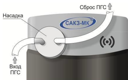
Рисунок Ж.1 – Установка насадки для подачи ПГС
