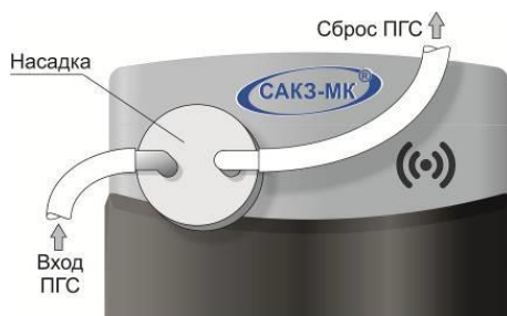
Рисунок И.1 – Установка насадки для подачи ПГС
