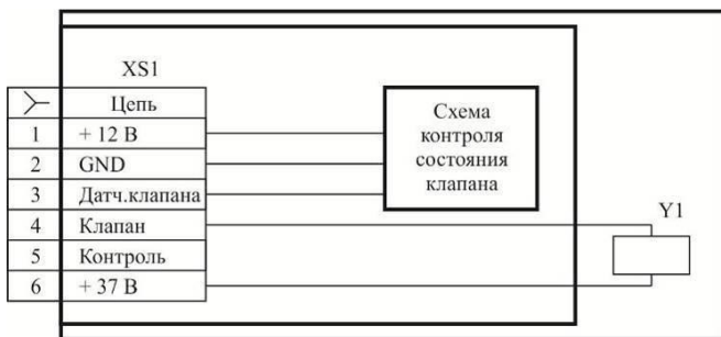
Рисунок 2 – Схема электрическая принципиальная клапана
